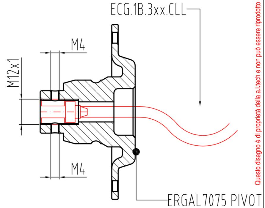
L'innesto rapido AIT-QR240/18 è realizzato per potere montare i connettori elettrici LEMO : ECG.1B.314.CLL - FAG.1B.314.CLA / ECG.1B.308.CLL - FAG.1B.308.CLA
